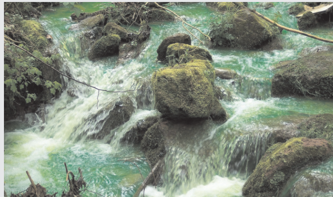
Markierungsversuch mit einem Tracerfarbstoff
